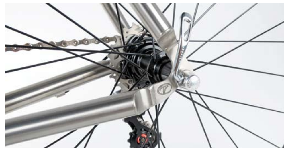
Die Campagnolo-Schnellspanner sind uralte, harmonisieren aber mit dem Rad. Auch hier: Nähte wie aus dem Lehrbuch der Schweißkunst
