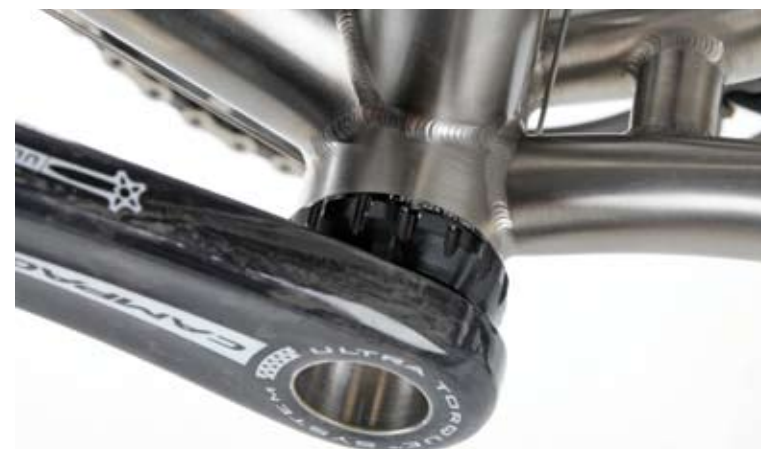
Unglaublich: die Schweißnähte. Beachten Sie den Quersteg: Nur Metallrahmen haben so etwas noch zur Verstärkung.
